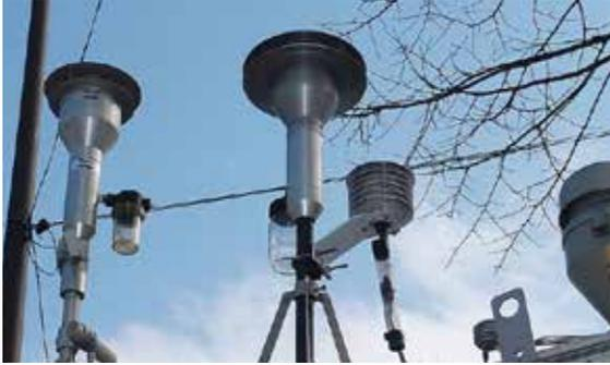
تتمثل مراقبة جودة الهواء في تتبع فضائي زمني لعدد من المعايير المؤشرة للتلوث قصد تعيين مستوى جودة الهواء بالنظر إلى المعايير المحددة بالقانون. وتستند مراقبة جودة الهواء على طرق التقييم المتنوعة قياس وتوقع مستويات التلوث في الهواء. هذا ما جعل جماعة الدار البيضاء تؤكد على مدى انخراطها في تحسين جودة العيش للسكان بتوسيع شبكة محطات مراقبة جودة الهواء تعمل وفق برنامج سنوي يشمل المناطق الصناعية بالمدينة.
